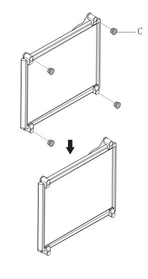
※VESAプレートの穴のサイズに合わせどちらかお選びください。 M4ネジをご使用の場合は必ず付属のワッシャーを使用して取り付けてください。
