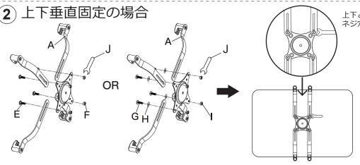
上下ともにVESAプレートの外側の ネジ穴を使い固定して下さい。
