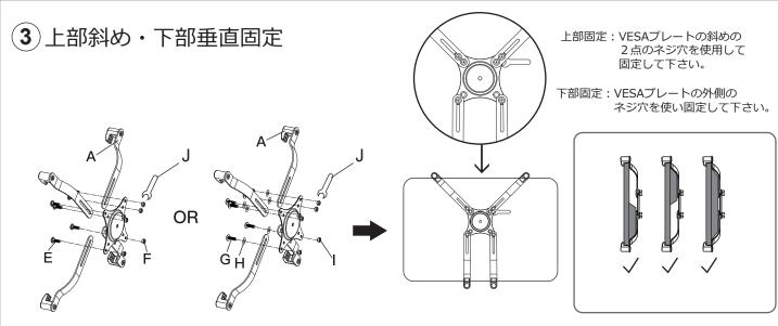
※VESAプレートの穴のサイズに合わせどちらかお選びください。 M4ネジをご使用の場合は必ず付属のワッシャーを使用して取り付けてください。
