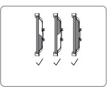
※VESAプレートの穴のサイズに合わせどちらかお選びください。 M4ネジをご使用の場合は必ず付属のワッシャーを使用して取り付けてください。
